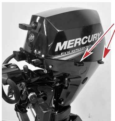
Нижние бамперы кожуха на левом боку
