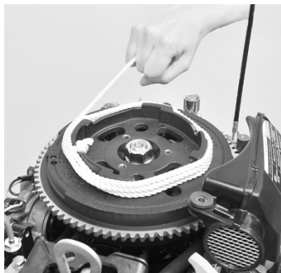
Трос аварийного пуска на маховике
