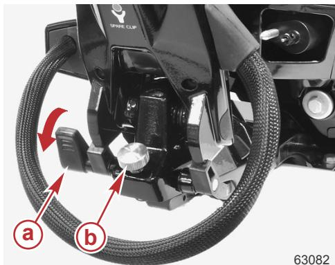
a. Маховичок регулировки в крайнем нижнем положении.
