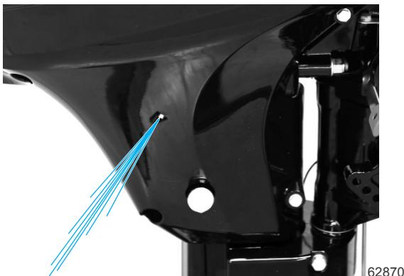
**ВАЖНАЯ ИНФОРМАЦИЯ:** Если вода не выходит из индикаторного отверстия водяного насоса, остановите двигатель и проверьте, не засорился ли заборник охлаждающей воды. Отсутствие засорения может указывать на повреждение водяного насоса или на закупоривание системы охлаждения. Эти проблемы могут вызвать перегрев двигателя. Обратитесь к дилеру для проведения проверки подвесного двигателя. Эксплуатация перегревшегося двигателя может привести к его серьезному повреждению.
