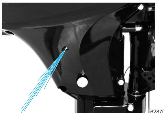
Если вода не выходит или выходит прерывистой струей из индикаторного отверстия водяного насоса, заглушите двигатель и проверьте, не засорены ли входные отверстия заборника охлаждающей воды. Если засорения не обнаружено, это может указывать на закупоривание системы охлаждения или на проблему с водяным насосом. Эксплуатация перегревшегося двигателя может привести к его серьезному повреждению.
