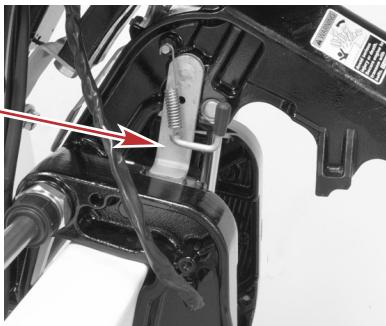
**a -** Рычаг опоры механизма наклона
