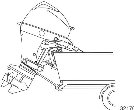
**ВАЖНАЯ ИНФОРМАЦИЯ:** Не полагайтесь на то, что система наклона или рычаг механизма наклона будет поддерживать необходимый просвет при буксировании. Рычаг механизма наклона подвесного двигателя не предназначен для удержания подвесного двигателя при буксировании.
