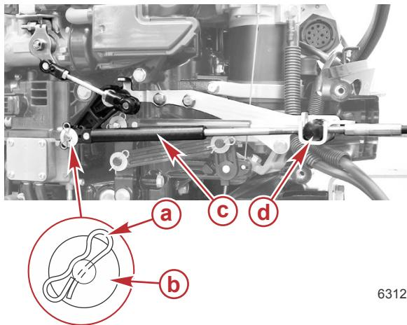
6. Установите фиксатор цилиндра троса и закрепите с помощью винта. Затяните винт с указанным моментом затяжки.
